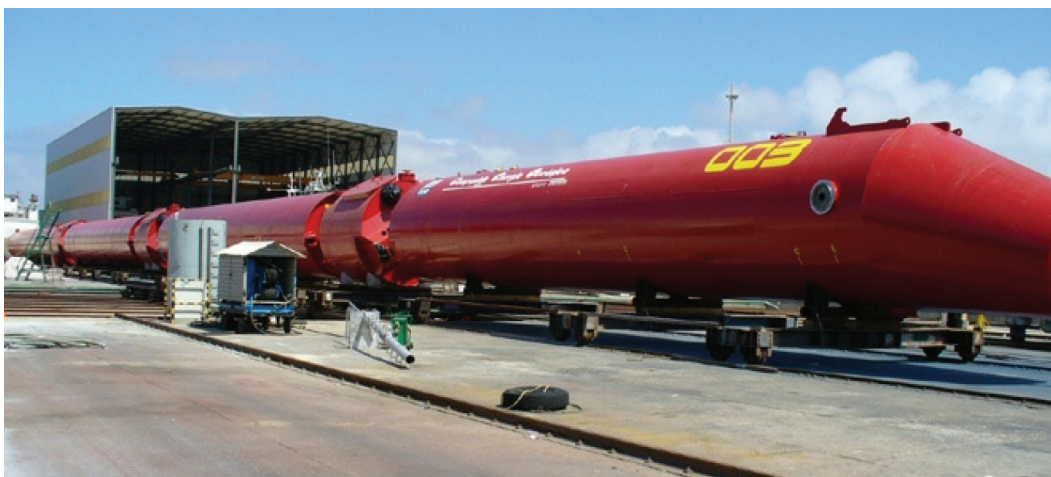
Figura 23 - Pelamis: montagem da instalação em Povo do Varzim
