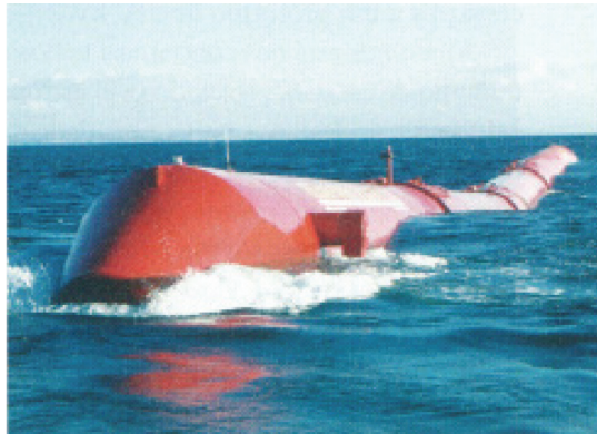
Figura 8 – Equipamento Pelamis em operação
